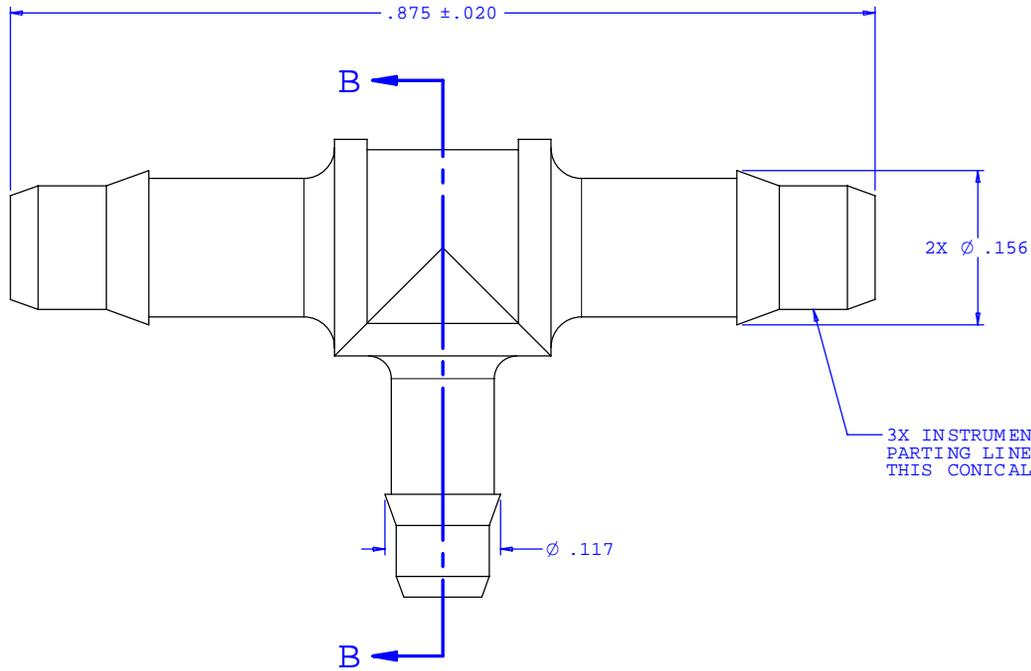
3X INSTRUMENT QUALITY PART. NO PARTING LINE PERMITTED ON THIS CONICAL SURFACE
