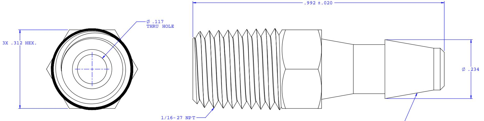
INSTRUMENT QUALITY PART. NO PARTING LINE PERMITTED ON THIS CONICAL SURFACE
